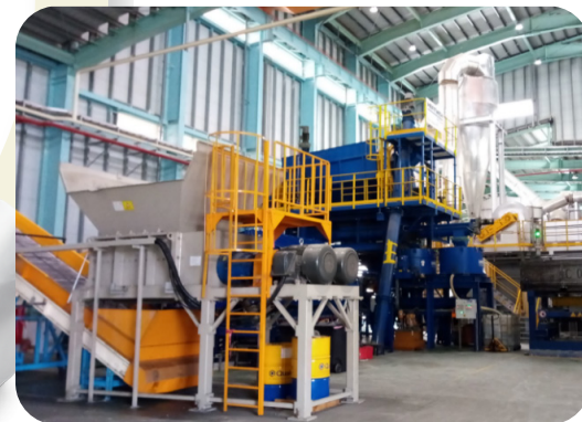
圖 1、圖 2 說明：高溫主爐體熱氣回收再利用 藉由爐體設計，將高溫熱氣回收再利用來乾燥鋁屑，前處理製程能減少天然氣的使用量達 100%。
